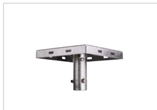
AKRON 4 60242 NEXT 2 - NEXT 3 - NEXT 4 - NEXT 6 - NEXT 8 Accessorio in acciaio zincato a caldo per montaggio n. 4 proiettori per pali Ø 76 mm max. Hot deep galvanized sheet steel accessory for max 4 floodlights, for pole max ø 76 mm.
