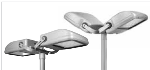
AKRON 2 60237 Per montaggio di due apparecchi a testa palo Ø mm 60, costituito da un blocco gemello in lega di alluminio pressofuso, verniciato in colore Silver.
